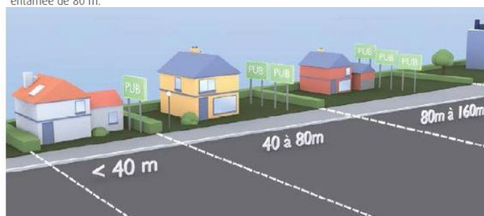
Un dispositif dans l'unité foncière dont la longueur bordant la voie est inférieure ou égale à 40 m. Deux dispositifs entre 40 m et 80 m. Un dispositif supplémentaire par tranche entamée de 80 m.
